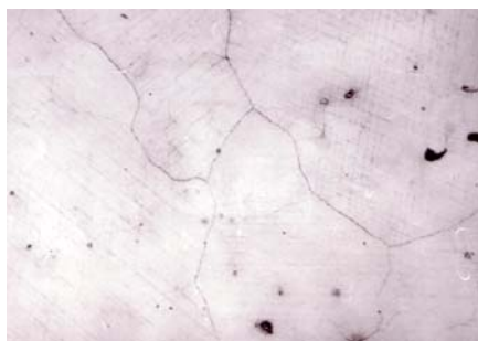
Rys. 1. Mikrostruktura staliwa Fermanal (0,97% C, 20,45% Mn, 5,25% Al).
