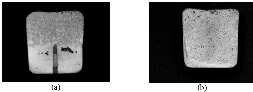
Rys. 2. Wlewki kompozytowe po procesie homogenizacji: a) w warunkach ciśnienia atmosferycznego, b) homogenizacji w obniżonym ciśnieniu. Fig. 2. Composites ingot after homogenizing: a) at atmospheric pressure, b) at reduced pressure.
