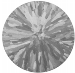
Rys. 4. Makrostruktura próbki 0 f=0\text{Hz} , I=0\text{A} , t=0\text{s} , M=0\text{ppm}(\text{Ti+B}) Fig. 4. Macrostructure of sample number 0
