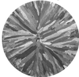
Rys. 6. Makrostruktura próbki 02 f=0\text{Hz} , I=0\text{A} , t=0\text{s} , M=50+10\text{ppm}(\text{Ti+B}) Fig. 6. Macrostructure of sample number 02
