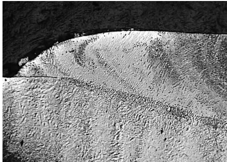
Rys. 2. Brzeg przetopienia warstwy wierzchniej stali po stopowaniu przy parametrach: prędkość skanowania – 0,5 m/min, moc wiązki – 1,5 kW, grubość powłoki WC – 0,11 mm.
