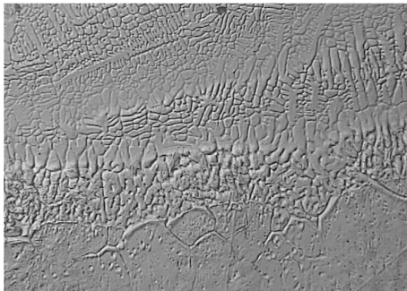
Rys. 3. Granica strefy przetopionej warstwy wierzchniej stali po stopowaniu przy parametrach: prędkość skanowania – 0,5 m/min, moc wiązki – 0,9 kW, grubość powłoki WC – 0,06 mm.
