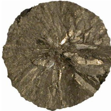
Rys. 5. Przelom staliwa FeAl22 Fig. 5. Fracture of FeAl22 cast steel
