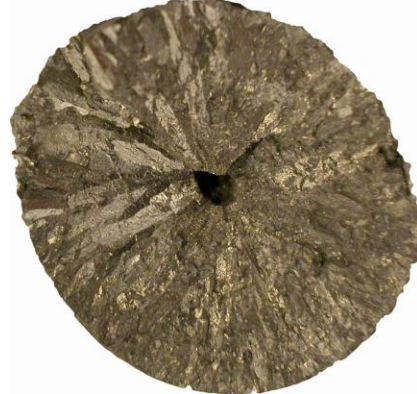
Rys. 4. Przelom staliwa FeAl16 Fig. 4. Fracture of FeAl16 cast steel
