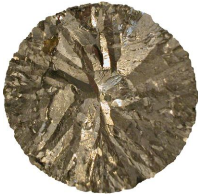
Rys. 3. Przelom staliwa FeAl12 Fig. 3. Fracture of FeAl12 cast steel
