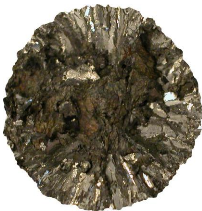
Rys. 1. Przełom staliwa FeAl6 Fig. 1 Fracture of FeAl6 cast steel
