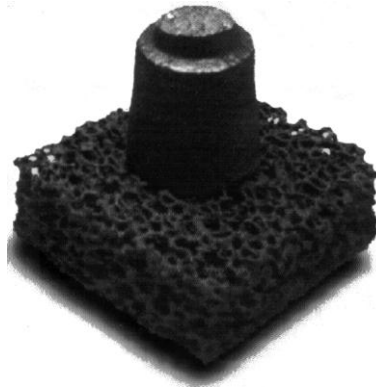
Rys. 2. Filtr ceramiczny piankowy z kostką modyfikującą Fig. 2. Ceramic foam filter with modifying cube
