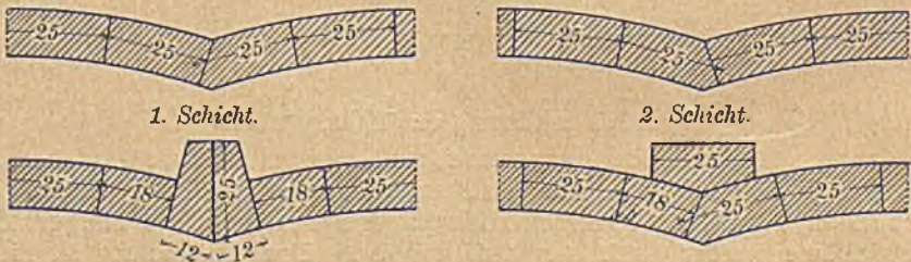
Abb. 37. Gratschnitte bei Kreuzgewölben ohne und mit Verstärkung.
