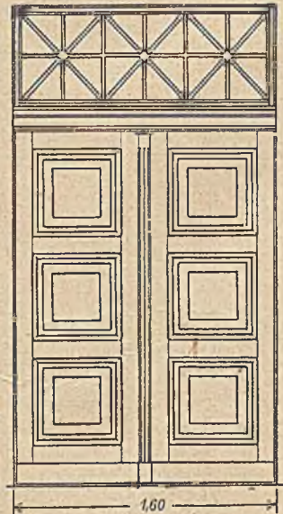
Abb. 236. Zweiflüglige Haustür mit Oberlicht. (Gleich breite Flügel.)
