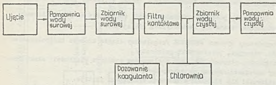
Rys. 1. Schemat technologiczny procesu uzdatniania wody.
