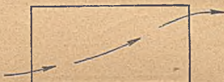
Bild 4 a wie 4, jedoch einseitige Luftzu- und -abführung.
