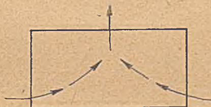
Bild 4 b wie 4, jedoch deckenmittige Luftabführung.
