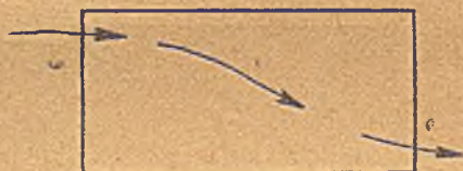
Bild 5 a wie 5, jedoch einseitige Luftzu- und -abfuhr.
