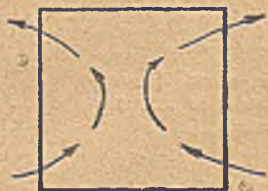
Bild 8, Lüftung von unten (untere Hälfte) nach oben, beiderseitige Luftzu- und -abführung.
