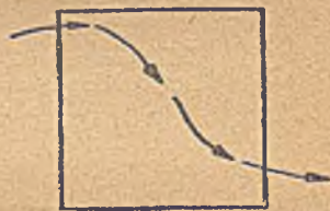
Bild 9 a wie 9, jedoch einseitige Luftzu- u. -abführung.
