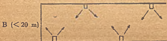
Bild 16. Zweireihig versetzte Anordnung, außenseitig.
