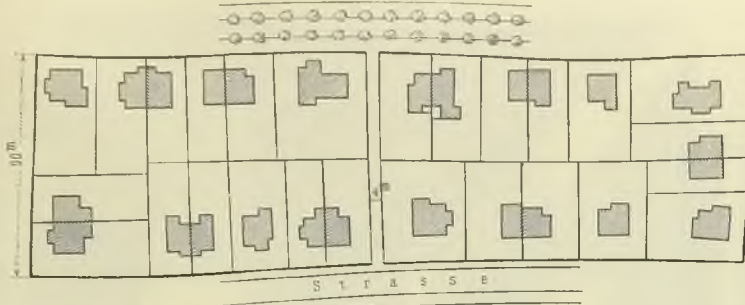
Fußweg zur Durchquerung eines langen Blocks bei offener Bauweise.
