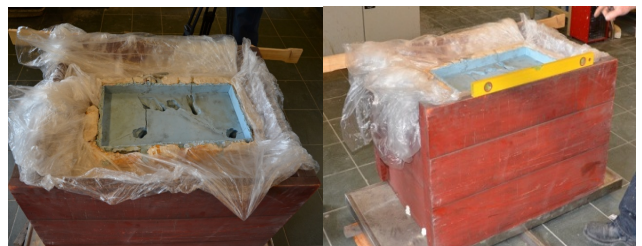
Rys. 8. Wypoziomowana i uszczelniona matryca, przygotowana do zalewania gipsem
