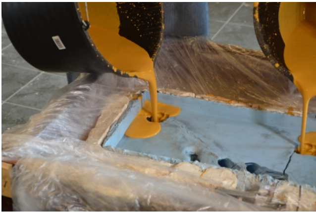
Rys. 9. Zalewanie matrycy gipsem IV klasy twardości
