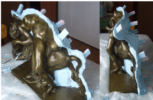
Rys. 5. Widok na wykonaną pierwszą część matrycy silikonowej wraz z widocznymi zaczepami pozycjonującymi ją podczas składania w pancerzu gipsowym
