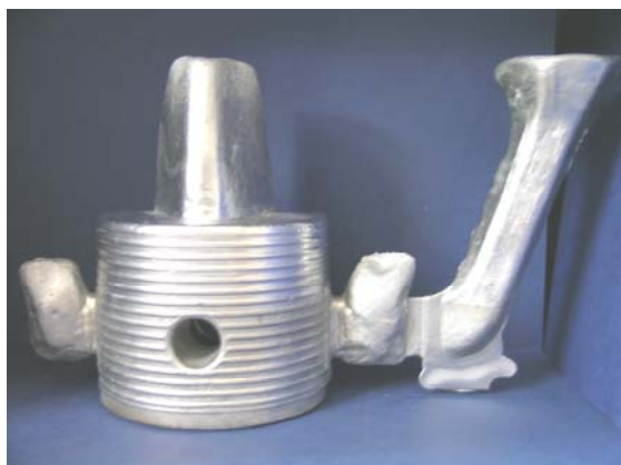
Rys. 2. Półfabrykat tłoka – odlew kokilowy.
