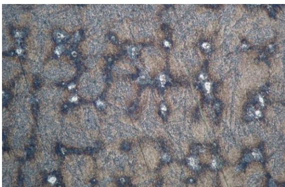
Rys. 8. Staliwo po hartowaniu i odpuszczaniu w 450°C (sorbite z poaustenitycznym układem dendrytycznym oraz węglki na granicach ziaren)
