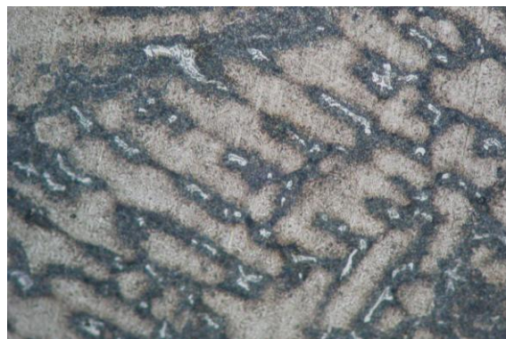
Rys. 9 Staliwo po hartowaniu i odpuszczaniu w 650°C (sorbite z poaustenitycznym układem dendrytycznym oraz węglki na granicach ziaren)
