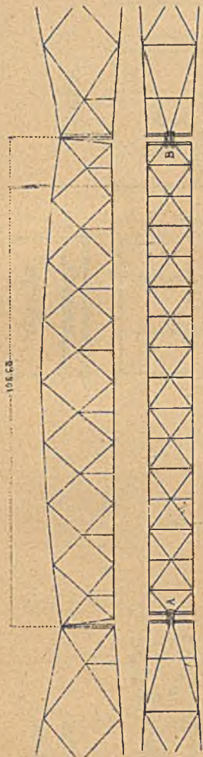
Rys. 2. Tężniki przy środkowym przęśle mostu na Forth.
