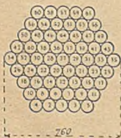
Rys. 14. Przekrój liny wiszącej z drutu stalowego na siodełku i przekroje prętów zakotwienia.
