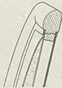
Abb. 121 u. 122. In den Falz eingenaelt Flachpolster
