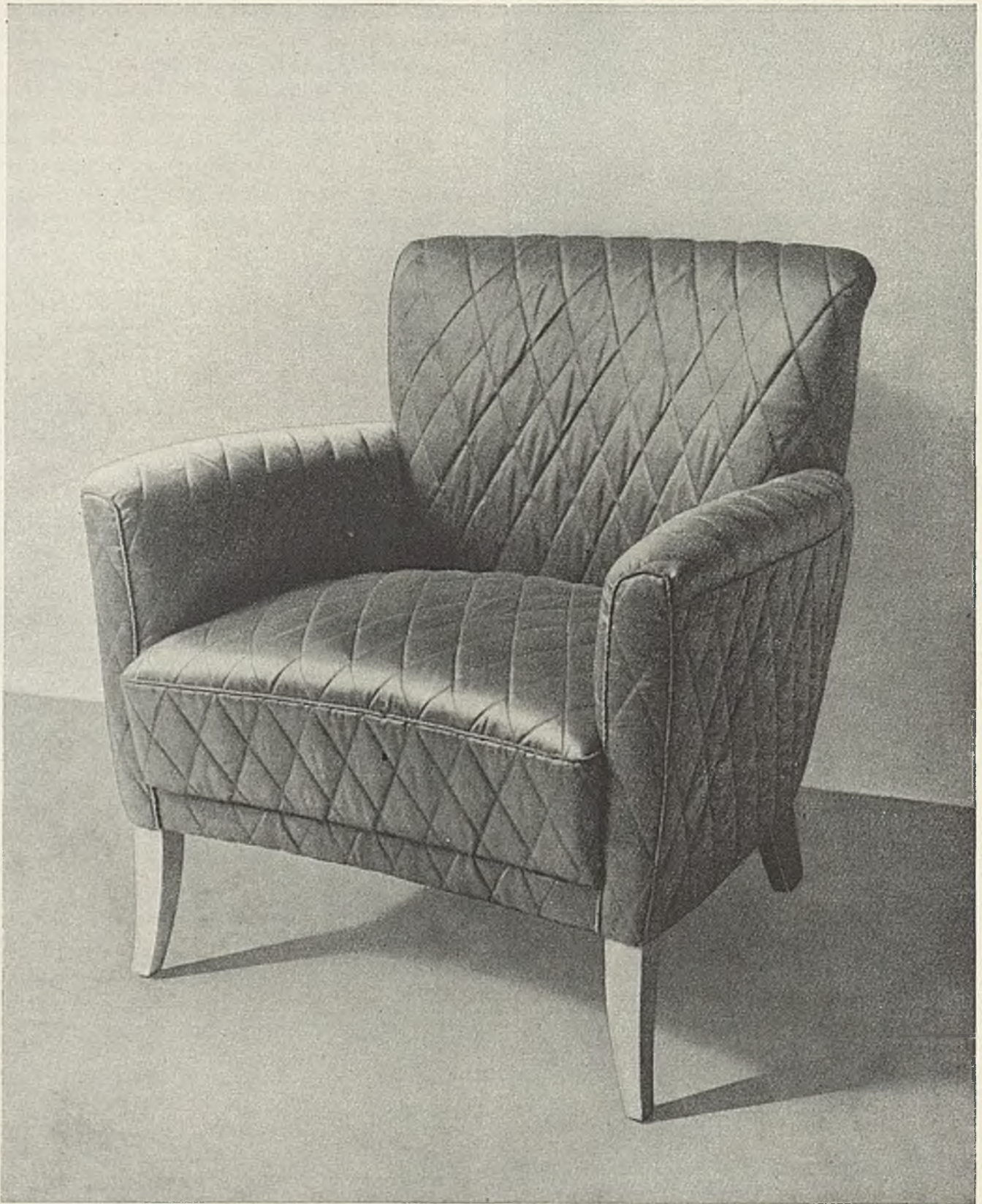
Abb. 429 (Entwurf: N., Hersteller: Zeschke, Berlin). Leichter Sessel mit diagonal-gesteptem und wattiertem Satinbezug. Seiten- und Rücklehne sind ohne Federung durchgeführt, während der Sitz zum erstenmal aus einem eingelegten Kissen besteht, das einen Federkern enthält. Das ansprechende Linienspiel auf dem Bezug steht im Einklang mit der Eleganz der gesamten Formen. Die einladende Geste bekommt der Sessel durch die leicht einwärts schwingende Sitzkante. (S. auch nebenstehenden Grundriß!)
