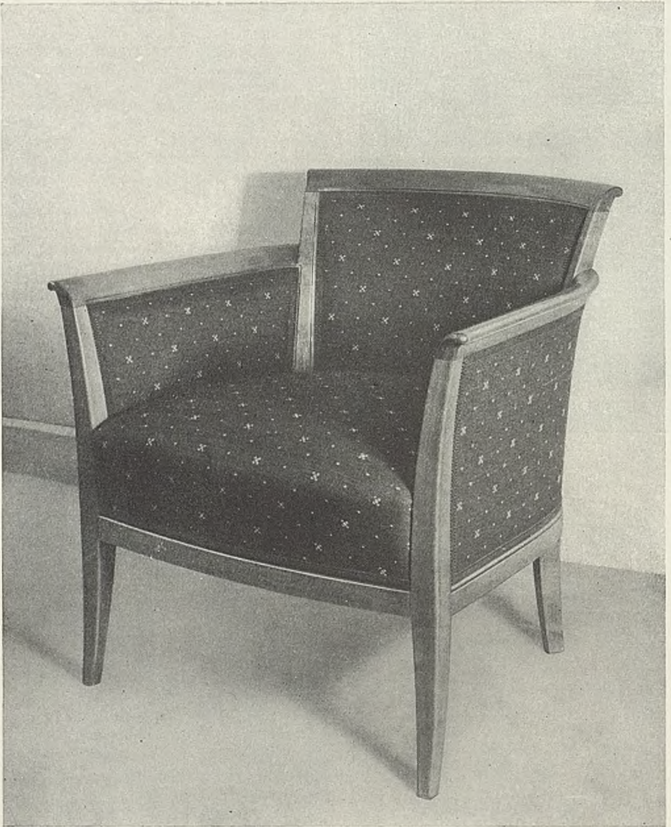
Abb. 406 (Entwurf: N. Hersteller: Zeschke, Berlin). Kleiner Damensessel, auch, geeignet für ein Kaffeehaus, mit sichtbar gebliebenem Holzgestell, für das sich Kirsche und Birnbaum gut eignen. Der Sessel kann einen hellen und empfindlichen Bezug erhalten, da die einer Verschmutzung am meisten ausgesetzten Stellen (Armlehnen und Kanten) in Holz belassen sind. Der Sitz besteht aus einem Federhochpolster mit Deutscher Kante, während Seitenteile und Rücklehne flach gepolstert sind. Das ganze Gestell hat Neigung nach hinten und erhält so trotz der eckigen Ausbildung von Seiten- und Rücklehne ein gefälliges Aussehen
