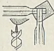
Abb. 170. Haltbare Verbindung von Sitzrahmen und Vorderbein
