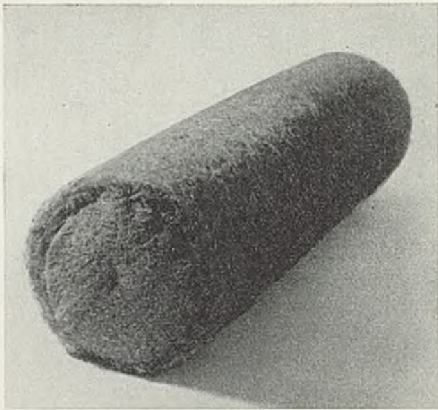
Abb. 510 u. 511 Kopfrolle, welche sich der Polsterer selbst gemacht hat. Aus einer Haargummiplatte, Abb. 452, stellt er eine Rolle her, die mit Fasern gefüllt und an beiden Enden mit Deckeln desselben Werkstoffes zugenäht wird. Daneben die fertige bezogene Rolle mit Knopfblende, welche die Stoffenden verdeckt
