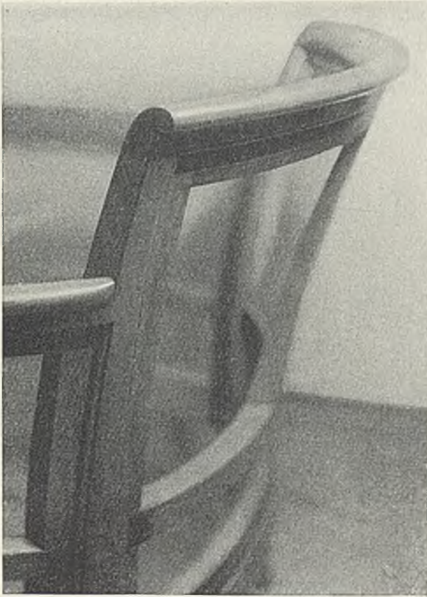
Abb. 410. Teilausschnitt aus dem Gestell. Deutlich sind die Fälze zu sehen, die an den stehenden Teilen, wie Füßen, meist eingeleimt und geschraubt und an Querhölzern meist angefräst werden. Zur weiteren Aussteifung erhielt die Rücklehne ein stehendes Mittelholz
