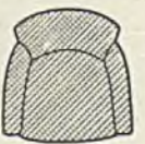
Abb. 340 (Entwurf: N. Hersteller: Zeschke, Berlin) zeigt einen leichten Polstersessel auf halbrundem Grundriß, dessen Sitz aus einem Federhochpolster mit Englischer Kante besteht, während Seitenteile und Rücklehne ohne Federn gepolstert sind. Hier hat das Polster vom ganzen Gestell Besitz ergriffen, weshalb dieses – zugleich auch für alle folgenden Sessel – auf der übernächsten Seite perspektivisch gezeichnet wurde. Deutlich zeichnet sich die Polsterauflage bei Sitz, Seitenteil und Rücklehne ab gegenüber allen übrigen Teilen, die glatt zugesponnt sind. Die Wulst der Englischen Kante (Polsterauflage) findet ihre Fortsetzung in dem Seitenteil und der Armlehnwulst und läuft in den Rücken über. Der klare Ausdruck des Sessels fußt auf einer klaren technischen Lösung
