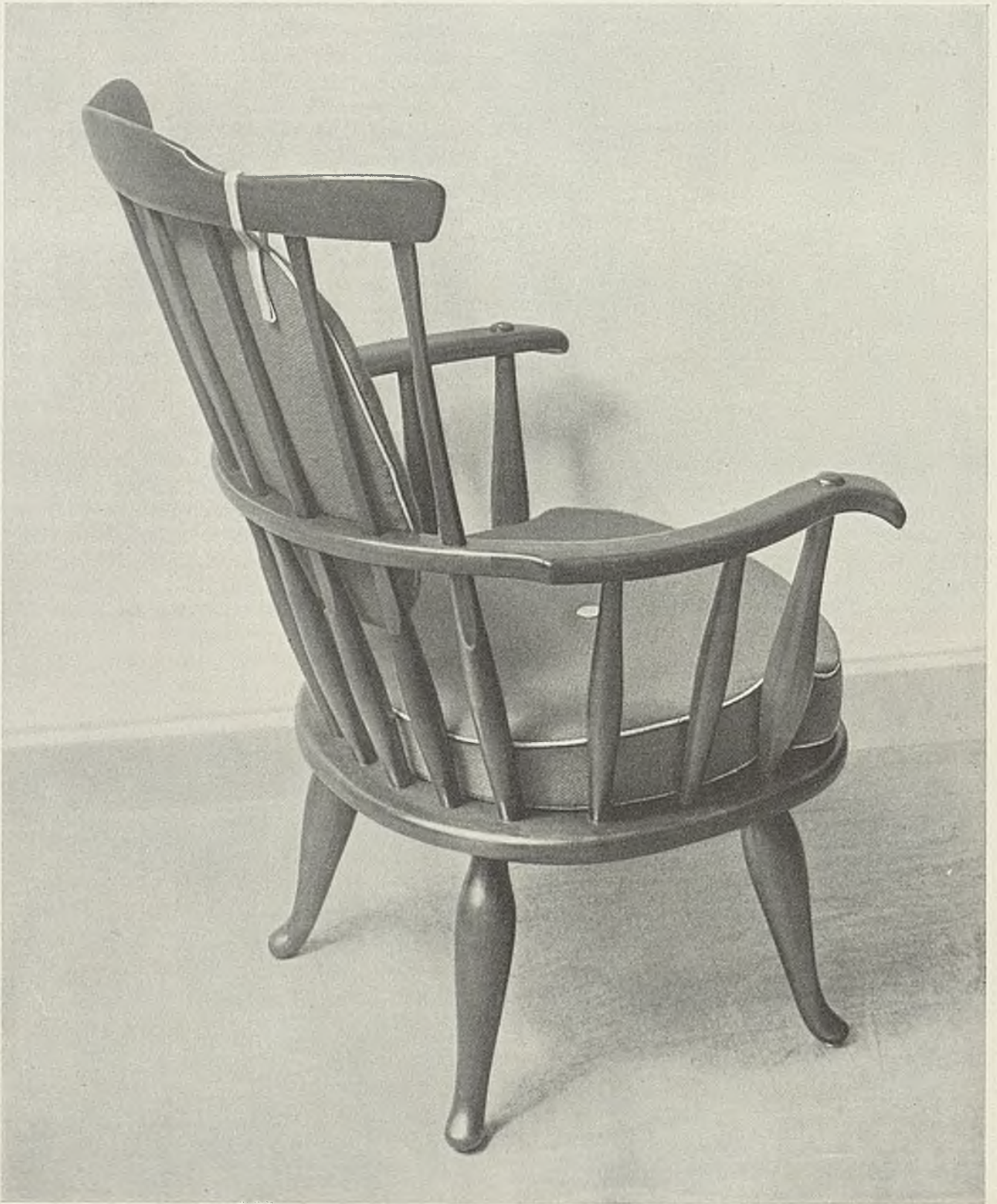
Abb. 634. Eleganter, hochlehner Armlehnstuhl für eine Diele oder an den Kamin in Nußbaumholz. (Entwurf: N. Hersteller: Zeschke, Berlin.) Der Typ stammt aus dem Englischen (Windsor-Typ). Das Sitzkissen hat einen Federkern und liegt auf einem ausgedrehten Brettsitz. Die Füße sind gedreht und deren Knäufe von Hand ausgearbeitet. Die elegante Liniensführung seiner dünnen Sprossen macht ihn leicht und durchsichtig und so auch für kleine Räume geeignet, die er nicht füllt
