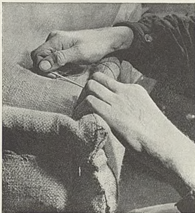
Abb. 447. An einem Federkissen wird die Kante garniert
