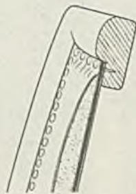
Abb. 121 u. 122. In den Falz eingenaelt Flachpolster
