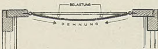
Abb. 253 und 254. Querliegende Spiralfedern auf Zug beansprucht
