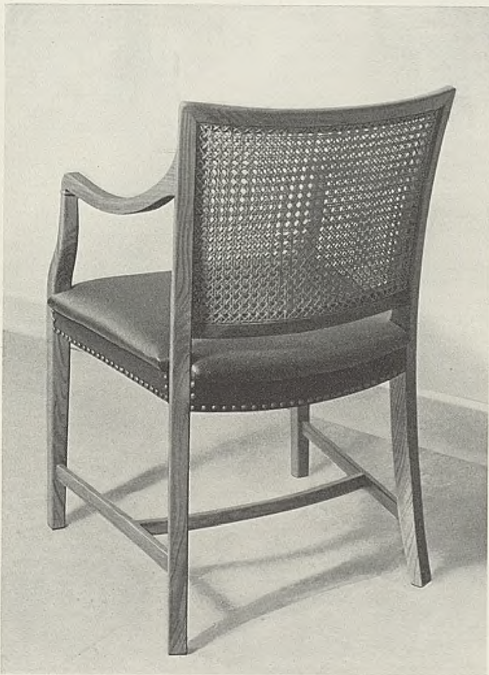
Abb. 604. Armlehnstuhl mit fliehend ausgebildeter Armlehnstütze für ein Speisezimmer aus Kirschbaumholz anpoliert. Der Sitz besteht aus einem Flachpolster mit einer sichtbaren Wulstkante, das mit frisch-grünem Kalbleder bezogen ist. Der Rücken ist mit doppelseitigem Rohr ausgeflochten. Die Armlehnausbildung ist auf Seite 41 unten Mitte, Abb. 128, dargestellt. (Entwurf: N. Hersteller: Zeschke, Berlin)
