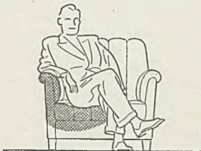
Abb. 612. Diese Zeichnung veranschaulicht an einem Sessel mit üppig geschwellten Polstern (Wesen der Polsterung), wie die Armlehne innen- und oben beansprucht wird. Die halbrunde Schwellung wird durch das Auflegen des Armes etwas flacher und breiter gedrückt, bleibt aber in ihrer Form erhalten
