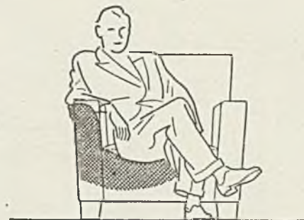
Abb. 613. Die Armlehne im Gebrauch an einem kubisch-kantigen Sessel (Auswirkung der Reißchiene). Die Innenkante wird eingedrückt, der überschüssige Stoff wirft außen Falten, die ganze Grundform ist zerstört. Die neu entstandene Form nähert sich derjenigen von Abb. 612
