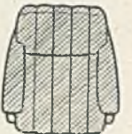
Abb. 362 (Entwurf: N. Hersteller: Zeschke, Berlin) zeigt einen reicheren Sessel, der auch auf eckigem Grundriß aufgebaut ist. Er hat hier einen mausgrauen Veloursbezug, Sitz und Rücken sind in Pfeifen abgeheftet. Die Schwellungen, sein ganzer Aufwand, verlangen eine üppigere Ausgestaltung der Armlehne, die hier zum erstenmal in Federhochpolsterung durchgeführt ist. Klar trennen sich die Polster von den glatten Sparnteilen
