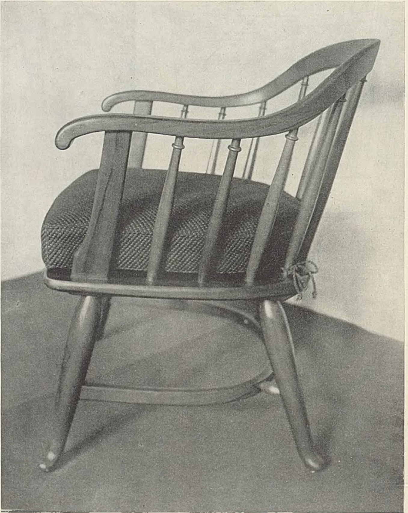
Abb. 30. Armlehnsessel in Nußbaum auf halbrundem Grundriß; der gegurtete Sitzrahmen trägt ein Kissen. Die Beine werden durch einen halbrunden Steg verbunden und versteift. Grundriß und Aufriß in Übereinstimmung. Entwurf: N. Hersteller: R. Zeschke, Berlin
