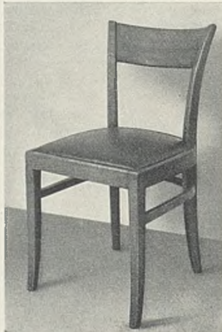
Abb. 592/593. Zargenstuhl aus Eiche auf halbrundem Grundriß (kein Zirkelrund). Starke Tailenbildung, das Hinterbein steht nahezu auf 45^\circ nach außen. (Entwurf: N.)
