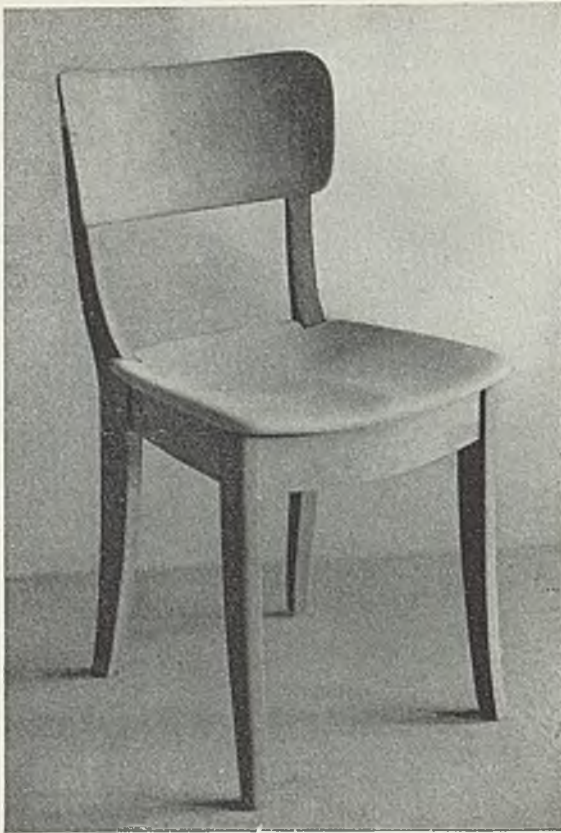
Abb. 772/773. Arbeitsstuhl, der in zwei Ausführungen mit verschiedenem Sitzgefälle hergestellt wird, einmal als Schreibstuhl, ebenso auch als Stuhl mit entspannender Sitzhaltung, wie er für Konzertsäle, Wartezimmer oder auch in der Wohnküche am Platze ist. Das Gestell ist aus Buchenholz, die Kanten sind weich gerundet. Der Sitz mit tiefer Mulde (aus Holzfaserverstoff gegossen) ist von höchster Bequemlichkeit, weil die Last des Körpers auf eine größere Fläche verteilt getragen wird, als es sonst der Fall ist. (Entwurf: N. Hersteller: P. Johannes Müller)
