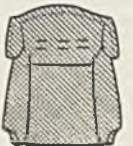
Abb. 439 (Entwurf: N., Hersteller: Zeschke, Berlin). Vollumpolsterter Ohrbackensessel mit großer Lage. Das mit Daunen gefüllte Sitzkissen liegt auf einer gefederten Grundpolsterung, wie auf Seite 161 abgebildet. Trotz seiner großen Ausmaße ist der Sessel elegant, seine Polster „gezügelt“, also nicht übermäßig dick. Die Ausformung der Spannteile an Seiten und Rücklehne in Verbindung mit seiner Lage geben der Gesamterscheinung des Sessels etwas „Bewegtes“!
