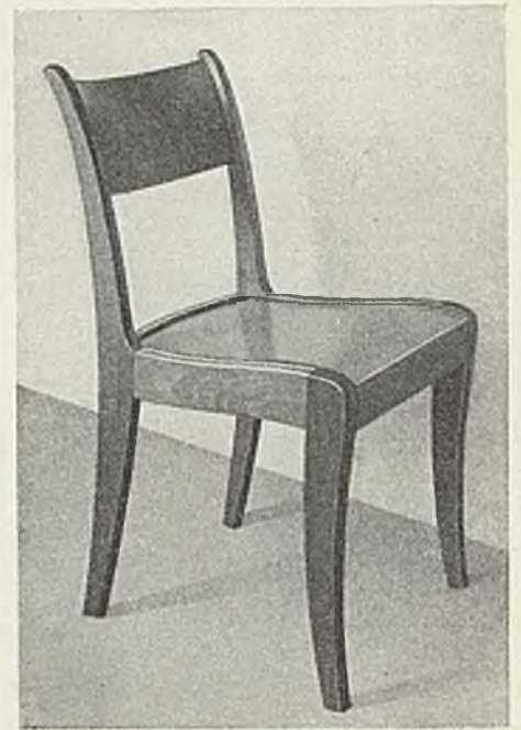
Abb. 94 u. 95. Zargenstuhl für Massenherstellung in Buche. Das Rückenquerstück ist im Modell geschweift abgesperrt. Die bewährte Verbindung von Zapfen und Dübel bei Abb. 84b findet hier Anwendung. Entwurf: N. Hersteller: P. Johannes Müller, Berlin
