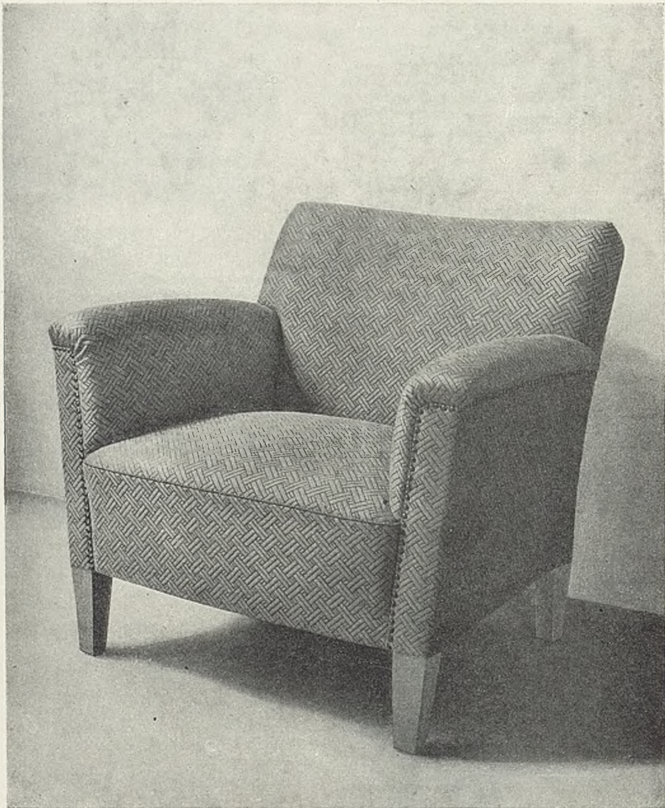
Abb. 348 (Entwurf: N. Hersteller: Zeschke, Berlin). Ein mittelschwerer Sessel auf eckigem Grundriß, wie er sich, ohne teuer zu sein, für Behörden und Büros eignet. Der schwere federhochgepolsterte Sitz mit deutscher Kante verlangt auch eine starke Rückenlehne, die hier erstmals in Federpolsterung ausgeführt ist. Die breite Armlehne erhält ein Polster mit Doppelwulst, das äußerst widerstandsfähig ist (um der Unsitte des Daraufsitzens zu begegnen) und die sich hier besser eignet als ein Federpolster
