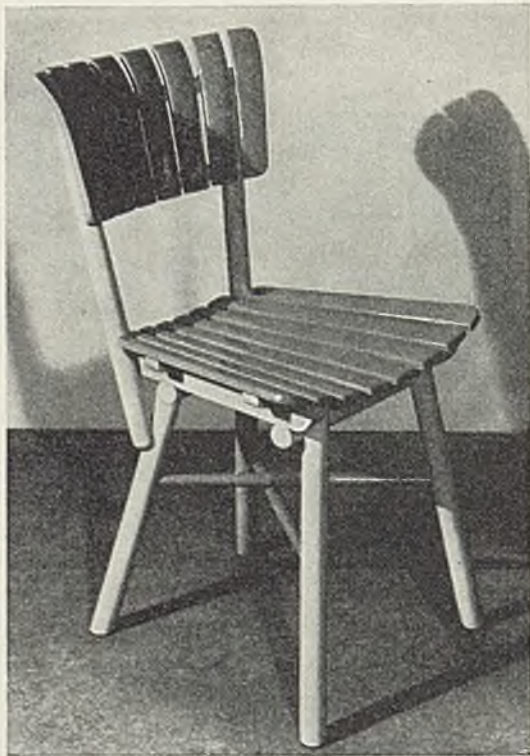
Abb. 727. Industriestuhl für den Kaffeehausgarten, zweifarbig lackiert. Seine gedrechselten Teile sind auf dem Automaten hergestellt. Die Rückenlehne stützt sich am Hinterbein ab. Dreieckverbindung wie Abb. 19a und 638. (Modell der Gebrüder Thonet AG.)
