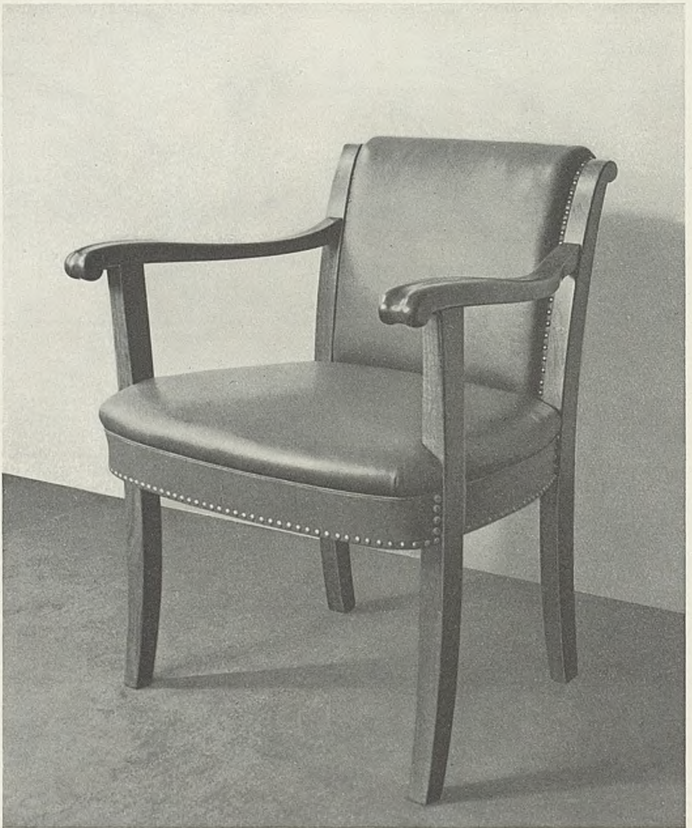
Abb. 332 (Entwurf: N. Hersteller: Bock & Feil, Marbach). Schreibessel aus Nußbaumholz mit kupferrotem Saffianlederbezug. Der Sitz hat ein Polster mit gefedertem Grund und läuft in einer Art Englischen Kante aus. Die Zarge ist glatt bezogen und mit blanken Metallnägeln abschließend genagelt. Der Rücken ist flach gepolstert. Sein Aufwand steht in richtigem Verhältnis zu dem des Sitzes. Das anpolierte Holzgestell bleibt in wesentlichen Teilen sichtbar. Die Armlehne sitzt auf dem verlängerten Vorderbein, das seitlich zurückgesetzt ist und endet klar in der sichtbar gelassenen Rücklehnstütze. Der Knauf der Armlehne und die Endigung der Rücklehn ergänzen sich in glücklicher Weise
