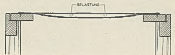
Abb. 263/264. Flachpolsterrahmen auf Gurtfedergrund
