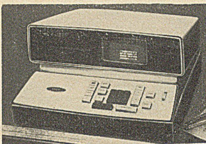
Rys. 15. Arystometr FRIEDEN-130. Wzór 1964. Precyzja 13-cyfrowa. 13 klawiszy operacyjnych, 3 rejestry operacyjne + 1 pamięć (wyświetlane stale na ekranie). Dodawanie 20 ms, mnożenie-dzielenie 400 ms. Gabaryty 46x53x25 cm, ciężar 20,0 kg. Rejestry zbudowane na liniach magnetystrycyjnych. Cena 6750 DM. Istnieje droższy model FRIEDEN-132, wzór 1965, posiadający 1 pamięć więcej i klawisz pierwiastkowania. Cena 10850 DM
