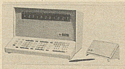
Rys. 20. Arystometr-kalkulator LOCI-2. Wzór 1965. Posiada dodatkowych 16 pamięci, umożliwia dołączanie przystawek programodawczych (80 kroków). Maks. czas 1 operacji 40 ms. Ciężar zredukowany do 15,0 kg. Cena 2750-8450 $ w zależności od wyposażenia
