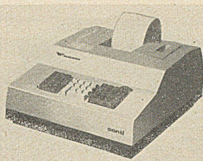
Rys. 8. Arytmometr CONTI, wzór 1966. Precyzja 16-cyfrowa, 23 klawisze operacyjne, od 0 do 6 miejsc zaprzecinkowych. 4 rejestry operacyjne + 3 pamięci. Akumulator 28-cyfrowy, drukarka 16-cyfrowa + 3 znaki operacyjne. Dodawanie 1 ms (!), mnożenie-dzielenie 80 ms. Gabaryty 38×20×49 cm, ciężar 25,0 kg. Cena 6850 DM. Za dopłatą można dołączyć dodatkowe 10 pamięci
