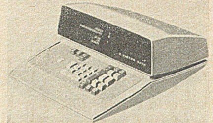
Rys. 29. Pierwszy arytmometr 3 generacji — VICTOR-3900. Wzór 1966, precyzja 20 cyfr, 17 klawiszy funkcyjnych, 3 rejestry + 2 pamięci. Gabaryty 28x28x19 cm, ciężar 12,7 kg. Cena w NRF poniżej 7000 DM
