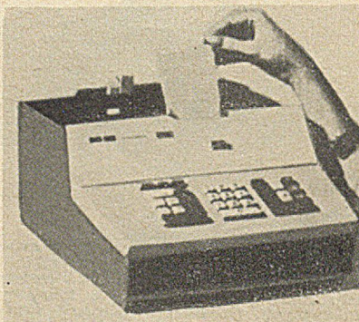
Rys. 13. Arytmometr EPIC-2000, wzór 1965. Precyzja 16-cyfrowa, 17 klawiszy operacyjnych, 2 pamięci. Dodawanie 4 ms, mnożenie 330 ms, dzielenie 250 ms, pierwiastkowanie 500 ms. Możliwość programowania pierwiastkowania sześciennego, logarytmowania i obliczania funkcji trygonometrycznych. Gabaryty (bez zasilacza) 29x32x22 cm. Programowalna repetycyjnie. Koszt ca 2000 $
