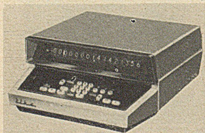
Rys. 11b. Arytmometr ELKA-22, wzór 1966. Widoczny odmienny układ klawiatury (brak klawisza do współpracy z maszyną do pisania). Nieco większe gabaryty 54x46x22, cięższy o 1 kg, pobór mocy zwiększony o 5 W
