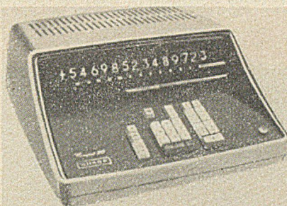
Rys. 9b. Arytmometr CS-20, widok ogólny. Wzór 1964. Klawiatura zminimalizowana, liczby dłuższe o 4 cyfry, 11 klawiszy operacyjnych, w tym uniwersalny klawisz do kasowania błędnie nastawionych liczb i operacji. Nie zawiera pamięci. Przyspieszona praca: dodawanie 6 ms, mnożenie-dzielenie 100 ms. Gabaryty 41×22×48 cm, ciężar 15,9 kg, pobór mocy 35 W. Zawiera 630 tranzystorów + 1880 diod. Cena ok. 4400 DM
