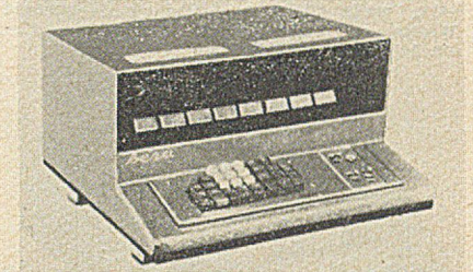
Rys. 31. Radziecki arytmometr WEGA, wzór 1965. Precyzja 21-cyfrowa, wyjście na wskaźnikach segmentowych, 3-rejestrowa. Mnożenie-dzielenie poniżej 1 sek, pierwiastkowanie poniżej 5 sek. Gabaryty 50x43x24 cm, ciężar 25,0 kg, pobór mocy 30 W. Zawiera 1303 ferryty, 1400 tranzystorów oraz diody. Początkowo sygnalizowana cena (3500 rubli) wydaje się wygórowana
