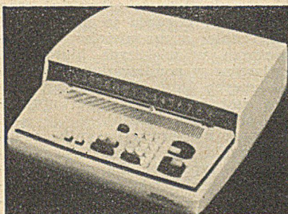
Rys. 17a. Włoski arystometr IME-84, wzór 1964. Pierwotna liczba 17 klawiszy funkcyjnych w modelu IME-84M została zmniejszona do 14 (na zdjęciu). Dodawanie 20 ms, mnożenie-dzielenie 300 ms. Precyzja 16-cyfrowa, 3 rejestry operacyjne. Gabaryty 47x45x15 cm, ciężar 13,6 kg, pobór mocy 50 W. Cena 4750 DM (modelu 84M tylko 4600 DM)
