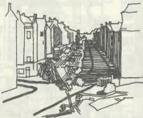
Rys.50. Przesunięcie jezdni w zacienioną stronę wnętrza Fig.50. Shifting the roadway to the shade side of the interior
