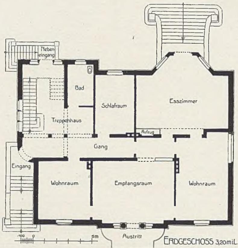
lichten Zimmerhöhen betragen 3,20 m im Erd- und 3,05 m im Obergeschosse. Die Wände sind teils rau, teils glatt geputzt, der Sockel durchweg rau; die Architekturteile wurden in Sandstein ausgeführt, die Fenster, Rinnen, Rohre und die sonstigen Holzteile sind weißgrau gestrichen, die Türen grün. Das Haus hat 45000 Mark gekostet. Wie leicht erkennbar, wurde die Einfriedigung nicht vom Architekten des Hauses angegeben.
