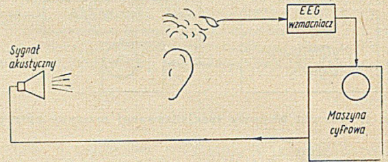
Rys. 6. Zestaw wykorzystywany przy wyznaczaniu odpowiedzi neuroelektrycznej na powtarzający się bodziec akustyczny
