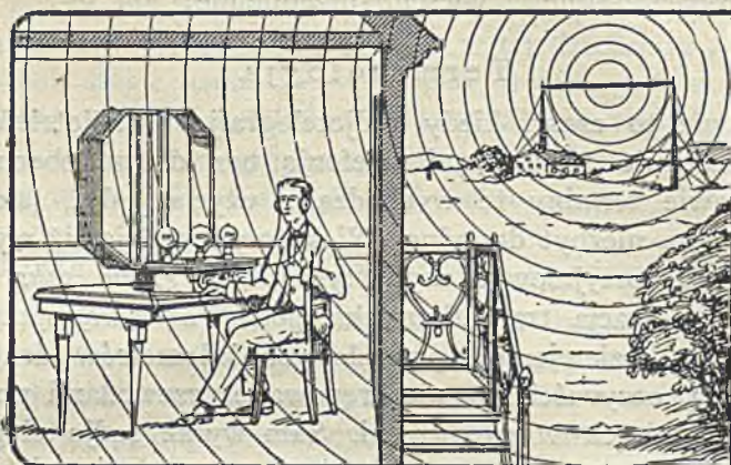
Antena ramkowa, w szczelnie zamkniętym budynku, chwyta fale elektryczne, promieniujące z anteny stacji nadawczej; żarzące się lampki stacji odbiorczej wzmacniają nagle zmienne impulsy i transformują je na prąd o stałym kierunku, który przedostaje się do obwodu słuchawki telefonicznej. Rysunek z Radioélectricité.
