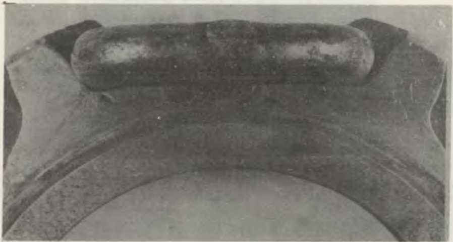
Rys. 6. Widok gniazda z powiększoną powierzchnią dna
