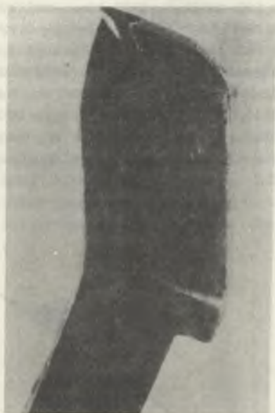
Rys. 3. Nóż z typowym zużyciem ściernym powierzchni przyłożenia
