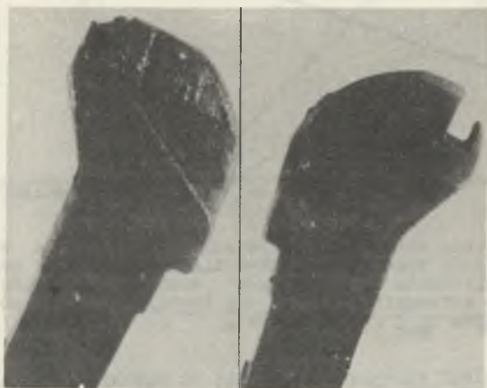
Rys. 5. Typowe uszkodzenia noży zbrojonych spiekami płytkowymi
