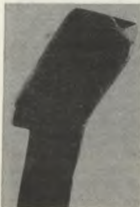
Rys. 8. Nóż, z którego w czasie pracy wypadł wałeczek z węglika spiekane go zbrojący ostrze
