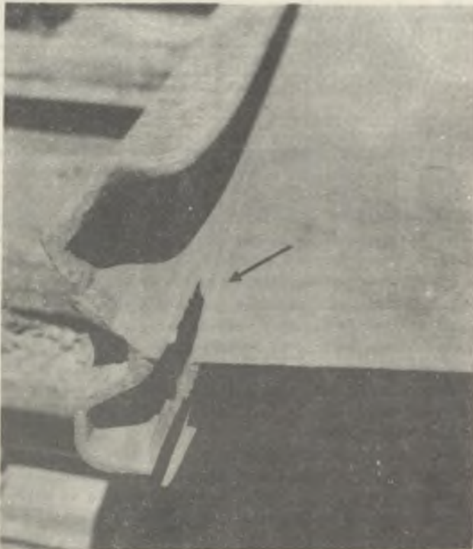
Rys. 2. Rynna wycofana z eksploatacji z widocznymi wytarciami
