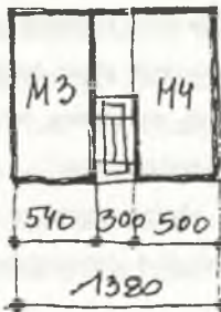
Rys. 3. Schemat rzutu segmentu pięciokondygnacyjnego WWP. Opracowanie Miastoprojekt Wrocław Fig.3. Projection scheme of a five-floor segment WWP Elaborated by Miastoprojekt Wrocław
