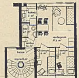
Stockholm. Grundriß mit 8 m Haus-tiefe. Arch.: Helge Zimndahl, Niels Ahrbom und Stig Ödeen. Baujahr: 1935. Bebaute Fläche: 45 qm.
