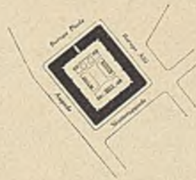
c) Borups allé, Borups plads Bauherr: Die Stadt Kopenhagen. Architekt: N. P. Gundstrup. Bauj.: 1928–29. Grundstücksgröße: 4753 qm. Bebaute Fläche: 2375 qm. Treppenhäuser: 18. Geschosse: 5.
