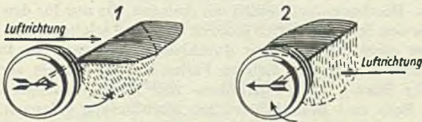
Abb. 99. Einbau im waagerechten Kanal.
