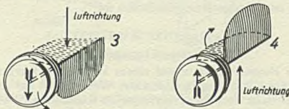
Abb. 100. Einbau im senkrechten Kanal.
