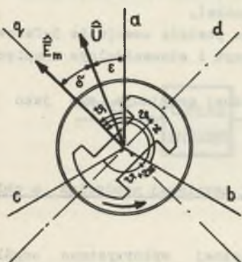
Rys. 3.2. Schemat przestrzenno-czasowy maszyny synchronicznej ( \alpha = \frac{2\pi}{3} )
