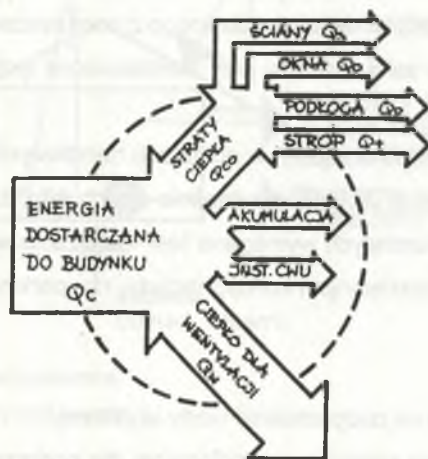
Rys.13. Bilans potrzeb ciepłych obiektów handlowych
