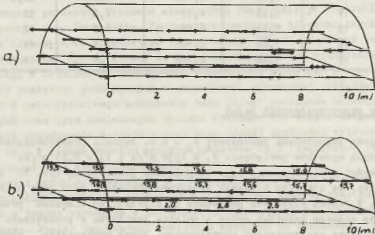
Rys. 4. Rozkład prędkości i temperatury powietrza, gdy s_p = 11 m: a) w = 8,2 m/s , \dot{v} = 1,4 m 3 /s , b) w = 15 m/s , \dot{v} = 1,44 m 3 /s
