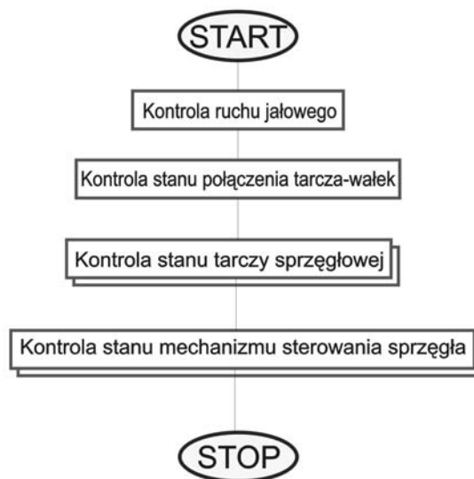
Rysunek 6.2: Poszukiwanie przyczyn niepełnego wyłączenia sprzęgła
