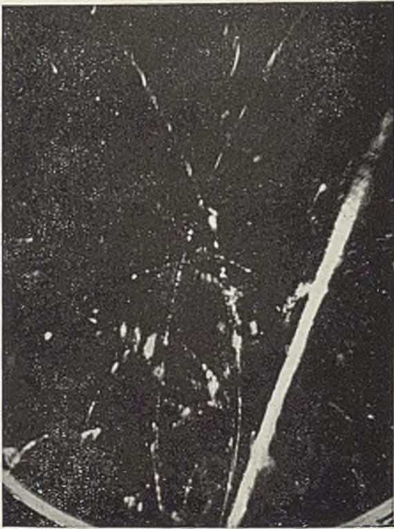
Fig. 2. — Electron positif et électron négatif issus d'une lame de Pb irradiée par les photons provenant du glucinium soumis à l'action des rayons \alpha de Po (Irène Curie et F. Joliot).
