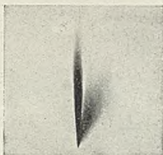
FIG. 2. — Déviation magnétique des rayons \beta du radium. Rayons non déviés \alpha et \gamma .
