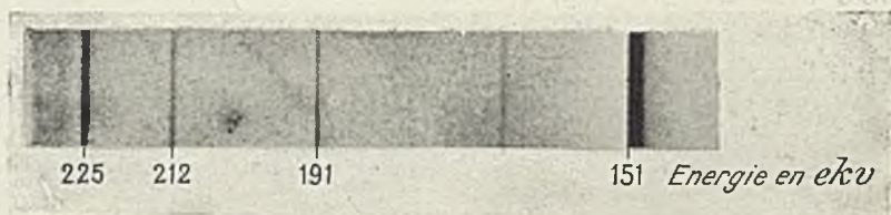
FIG. 5. — Spectre magnétique des rayons \beta de ThB + ThC . Méthode de focalisation (T. Graf).
