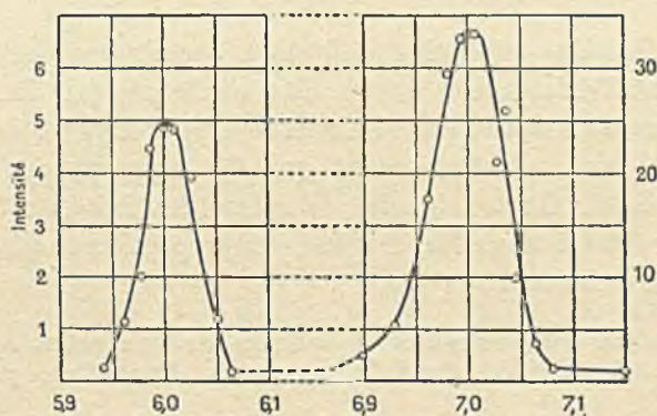
FIG. 39. — Lithium . Les deux maxima correspondent aux deux isotopes de masses 6 et 7, avec grand excès du second par rapport au premier, conformément à la valeur du poids atomique 6,94.
