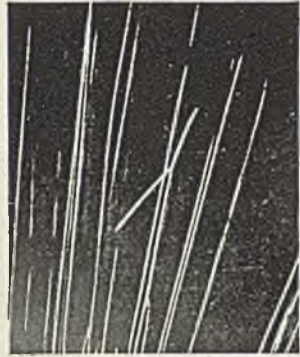
Fig. 2. — Choc contre un noyau d'azote. Le rayon \alpha réfléchi fait un angle de 1,42^\circ avec la direction initiale (Blackett et Lees).
