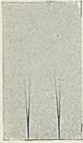
FIG. 1. — Rayons \alpha canalisés, déviés par un champ magnétique perpendiculaire au plan de la figure. Impression produite sur une plaque parallèle aux faisceaux (H. Becquerel).
