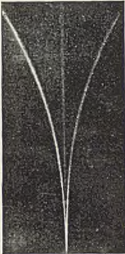
FIG. 3. — Impression directe produite par le faisceau de rayons dont la trajectoire est dans le plan de la plaque. Champ magnétique perpendiculaire à la trajectoire (Becker).
