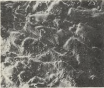
Fot. 3. Austriackie wyroby chromitowo-magnezytowe Ankrom D-6, kształtka nowa nie posiadająca kontaktu z cieczą. Fotografję wykonano na mikroskopie skaningowym, powiększenie 200x
