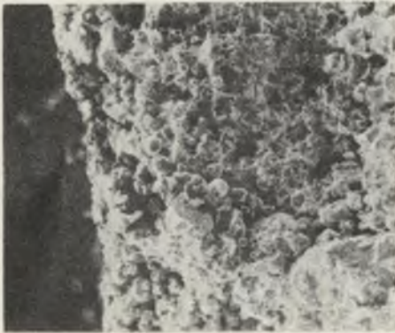
Fot. 5. Polskie wyroby chromitowo-magnezytowe CM-2 nasycone \text{Cu}_2\text{S} w czasie 6 dni. Warstwa granicząca z cieczą. Fotografję wykonano na mikroskopie skaningowym, powiększenie 200x
