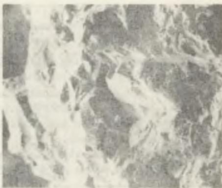
Fot. 18. Austriackie wyroby chromitowo-magnezytowe Ankrum D-6 nasycone białym matem w czasie 3 dni. Warstwa granicząca z cieczą. Fotografię wykonano na mikroskopie skaningowym, powiększenie 600x
