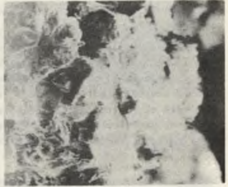
Fot. 4. Austriackie wyroby chromitowo-magnezytowe Ankrom D-6, kształtka nowa nie posiadająca kontaktu z cieczą. Fotografję wykonano na mikroskopie skaningowym, powiększenie 600x
