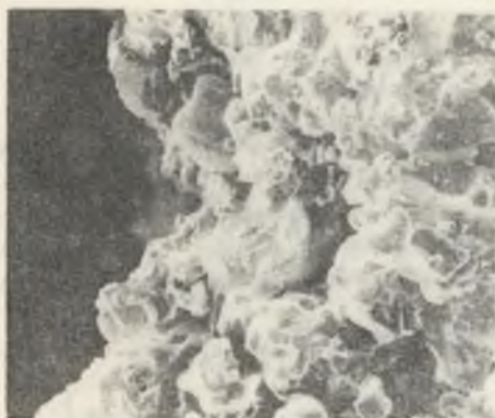
Fot. 17. Polskie wyroby chromitowo-magnezytowe CM-2 nasycone białym matem w czasie 3 dni. Warstwa granicząca z cieczą. Fotografię wykonano na mikroskopie skaningowym, powiększenie 600x
