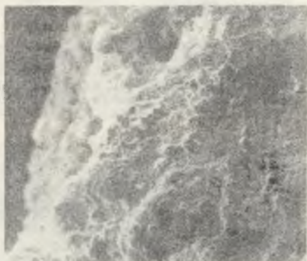
Fot. 7. Polskie wyroby chromitowo-magnezytowe CM-2 nasycone \text{Cu}_2\text{O} w czasie 3 dni. Warstwa granicząca z cieczą. Fotografię wykonano na mikroskopie skaningowym, powiększenie 600x
