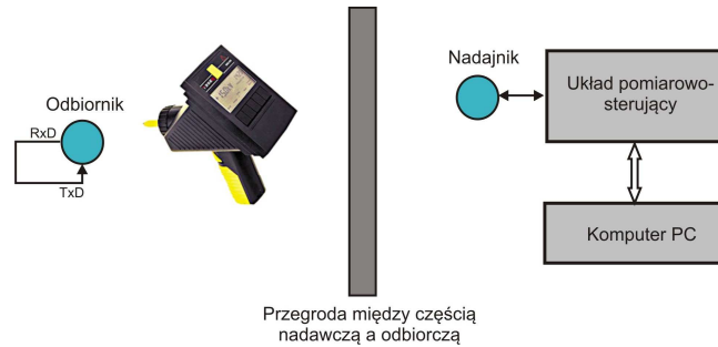
Rys. 6.14. Wygląd stanowiska pomiarowego do badania wpływu wyładowań elektrostatycznych na opóźnienia w sieci ZigBee
