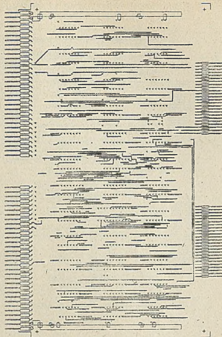
Rys. 5. Przykład A - Ścieżki metalizacji na stronie lutowania
