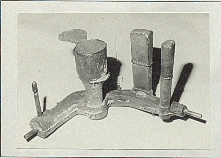
Rys. 60. Odlew zgrzewadła po wybiciu formy
