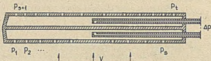
Rys. 1. Szkic budowy spiętrzającej rurki uśredniającej
