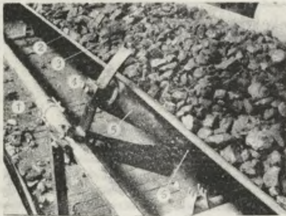
Rys. 3. Zestaw krążnikowy o zmiennym nachyleniu krążników bocznych, podtrzymujący taśmę przenośnikową wraz z nosiwem
