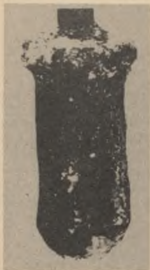
Rys. 28. Katoda z osadem otrzymanym w stopie \text{Na}_2\text{B}_4\text{O}_7\text{-NaF-TiO}_2
