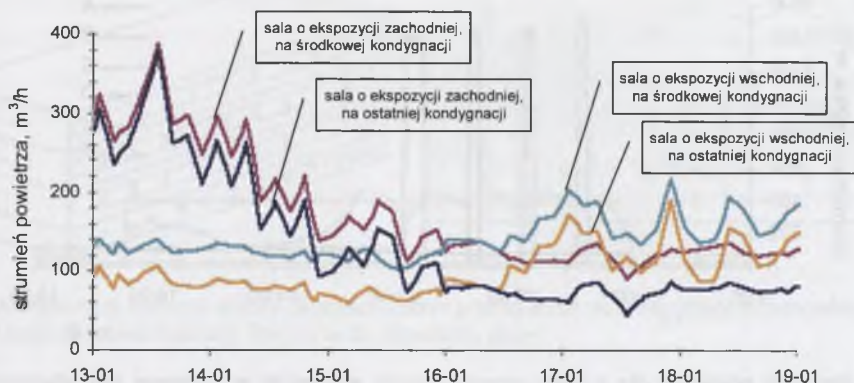
Rys. 4. Przebieg zmienności strumienia powietrza dla wybranego tygodnia sezonu grzewczego (wariant A) dla czterech przykładowych sal lekcyjnych o różnej ekspozycji
