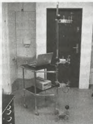
Rys. 2. Mobilny zestaw do pomiaru środowiska cieplnego pomieszczeń
