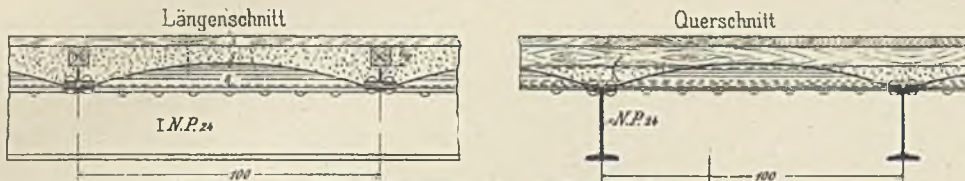
Fig. 1 Decke mit stehenden Buckelplatten.
