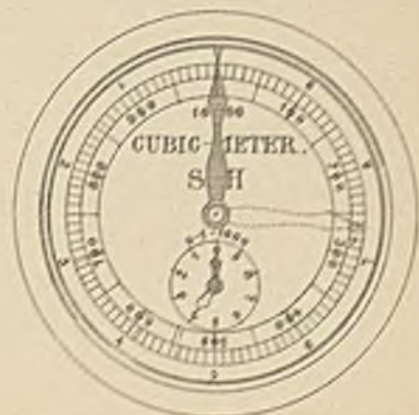
Fig. 3. Zeigerwerk mit rotirendem Zifferblatt.
