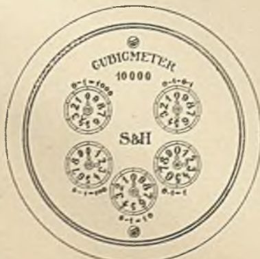
Fig. 4. Zeigerwerk mit feststehendem Zifferblatt.
