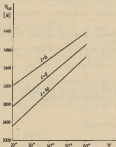
Rys. 3. Zależność napięcia udarowego N_{u2} gałęzi łańcucha ogniowego \emptyset 18 \times 64 , od kąta wierzchołkowego zębów koła gniazdowego
