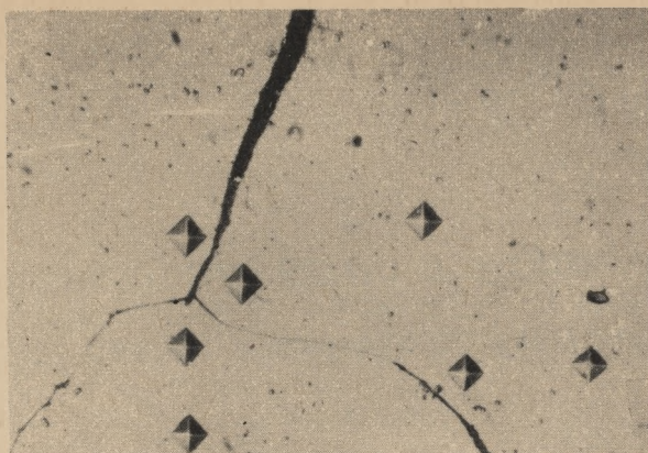
Rys. 59. Odciski z pomiaru mikrotwardości wykonane w ziarnach ferrytu żelaza „Armco” w pobliżu pęknięć korozyjnych
