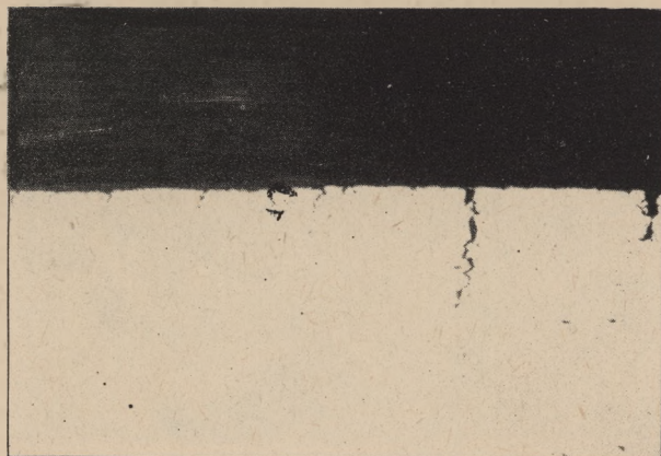
Rys. 55. Drobne pęknięcia korozyjne w warstwie powierzchniowej próbki stali 0,28% C, poddanej korozji naprężeniowej
