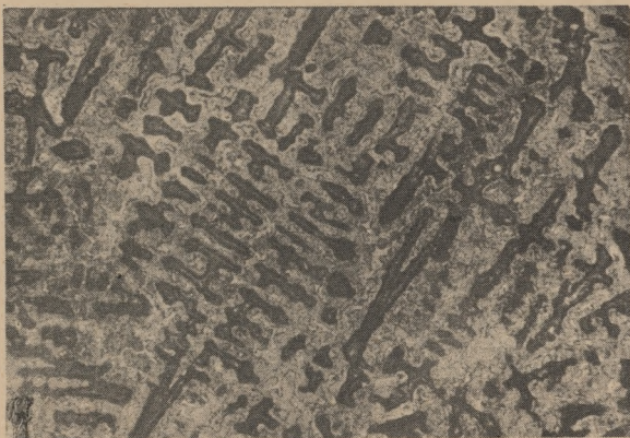
Rys. 31. Materiał 19. Brąz B 101 (100 X)
