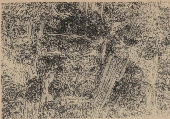
Rys. 22. Materiał 10. Zeliwo wysokochromowe (500 X)
