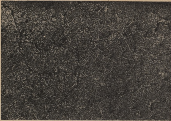
Rys. 34. Materiał 22. Brąz specjalny (100 X)
