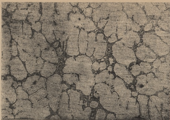
Rys. 37. Materiał 25. Silumin specjalny RR 53 c (100 X)
