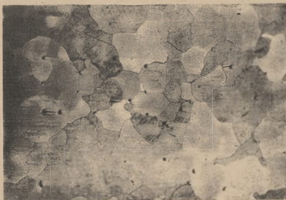
Rys. 26. Materiał 14. Staliwo Hadfielda G. 14 L (100 ×)
