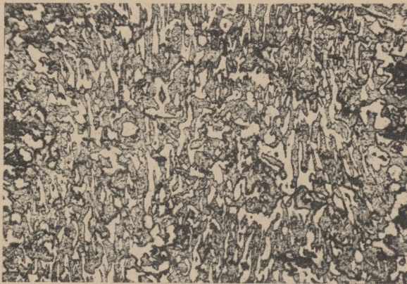
Rys. 29. Materiał 17. Staliwo wysokochromowe LH 17 (100 X)
