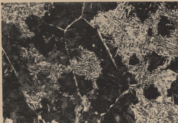
Rys. 25. Materiał 13. Staliwo ST 1 (500 ×)
