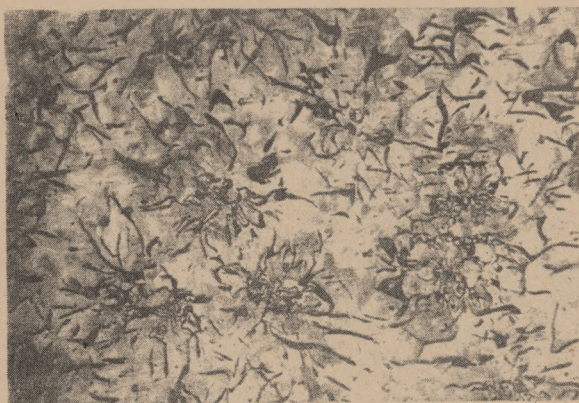
Rys. 14. Materiał 2. Żeliwo szare Żl. 22 (100 X)
