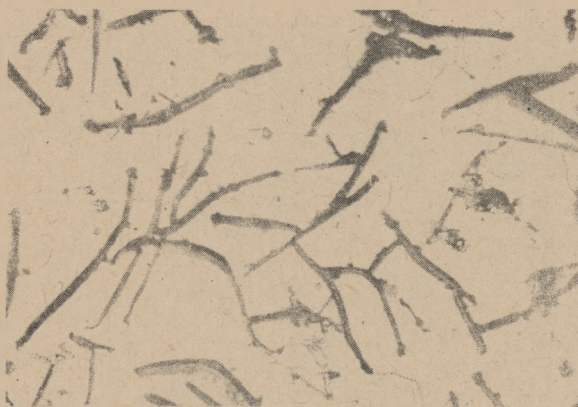
Rys. 20. Materiał 8. Zeliwo krzemowe (500 X)
