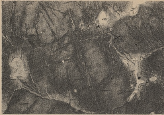
Rys. 28. Materiał 16. Staliwo wysokomanganowe (500 X)
