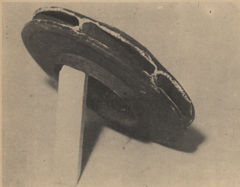
Rys. 40. Badania w laboratorium. Wirnik łopatkowy odlany z żeliwa szarego Żl. 18 (po 9 godz.)
