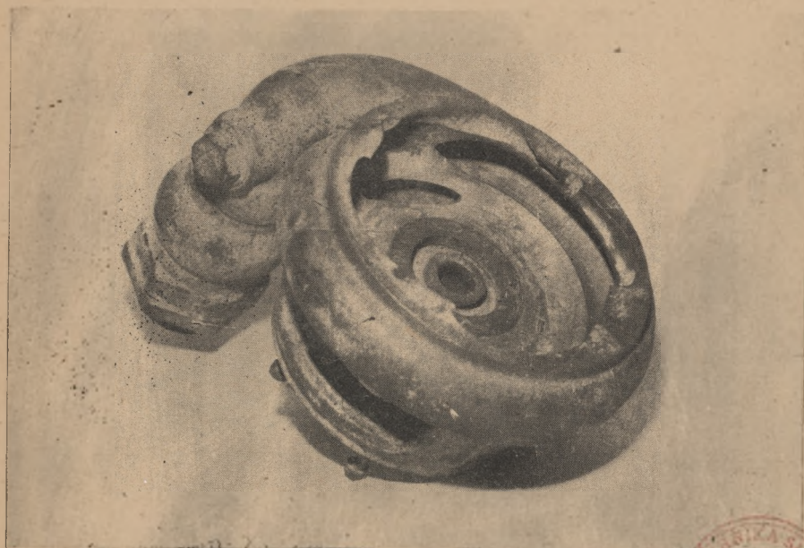
Rys. 50. Badania w laboratorium. Kadłub pompy EW-50 (po 606 godz.)
