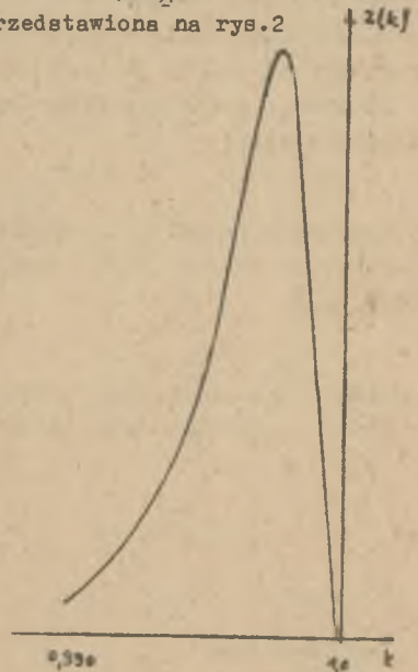
Rys. 2. Funkcja gęstości rozkładu współczynnika gotowości przenośnika PTG
