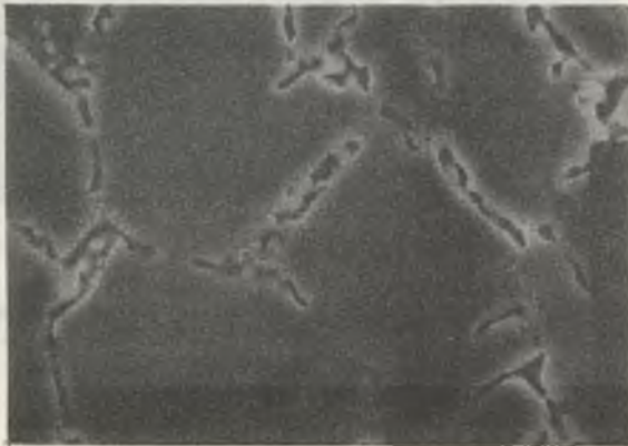
Rys. 48. Obraz w elektronach wtórnych stopiwa A2 po wygrzewaniu w temp. 750°C aż do zaniku ferrytu delta. Widoczne wgłębienia po fazie sigma. Pow. 3000x. Trawienie elektrolityczne
