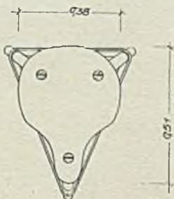
Modell 118. Dreieckiger Zeichenhocker. Die Mitte des Sitzes kann ausgearbeitet werden, um eine bequeme Sitzfläche zu schaffen
