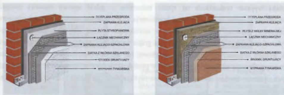
Rys. 1. Przekrój systemu ocieplania ścian zewnętrznych budynków z zastosowaniem styropianu i płyty z wełny mineralnej jako warstwy termoizolacyjnej
